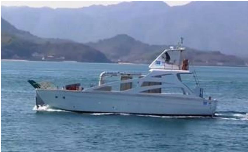
(Embarcação movida por duas pilhas de combustível de 30 Kw da Ballard Power Systems. É utilizado um sistema de energia híbrido composto por uma bateria de lítio de 60kWh e os dois módulos FCveloCity-MD produzindo um total de 60 kW de potência).
