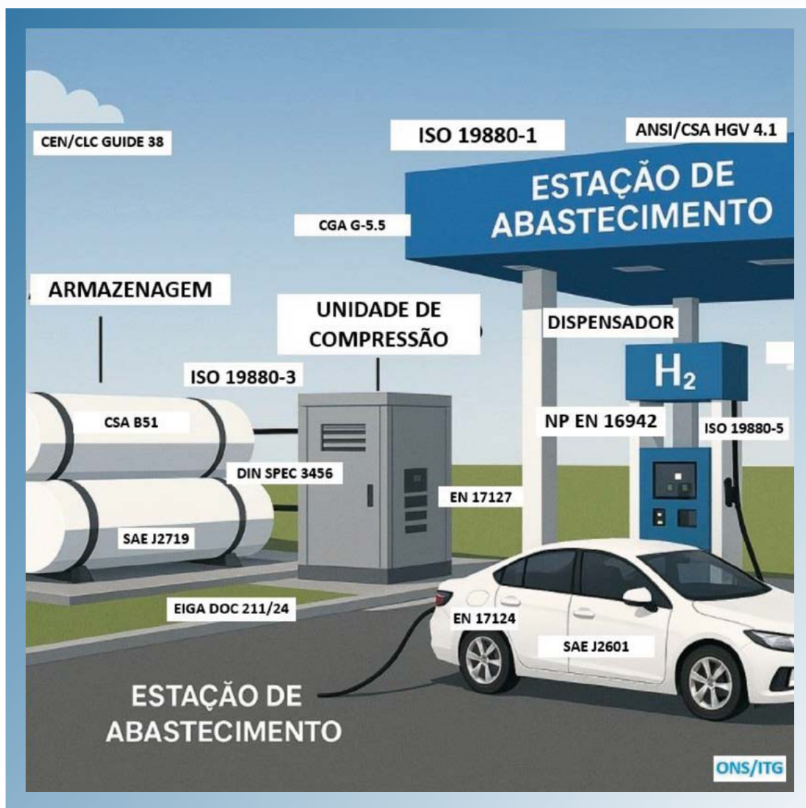
▲ Figura 1: Representação das normas aplicáveis a uma estação de abastecimento de hidrogénio gasoso
