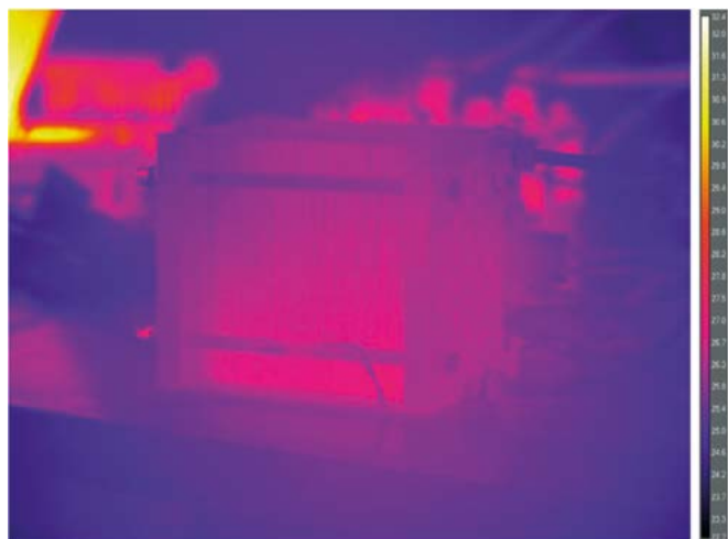
◀ Figura 4: Monitorização da temperatura da célula de hidrogénio com recurso a uma câmara termográfica
